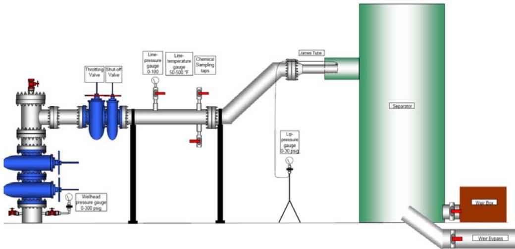
**Figure 1.** James-tube, Atmospheric Separator and Weir Box
